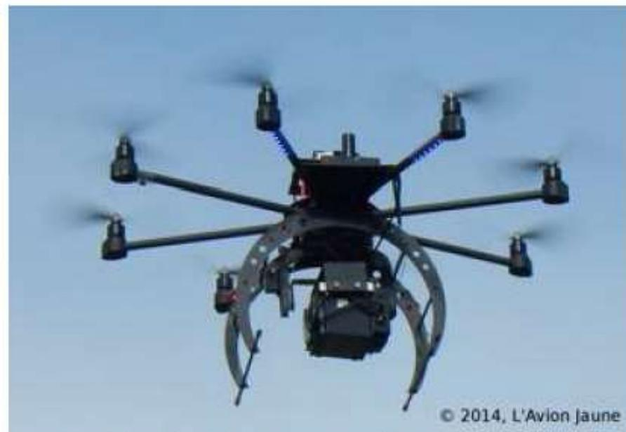
Le LIDAR YellowScan® monté sur un multirotor OnyxStar Fox C8HD
