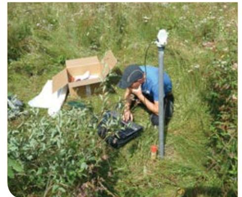
Installation d'un piézomètre pour tester le protocole du programme LigéRO
