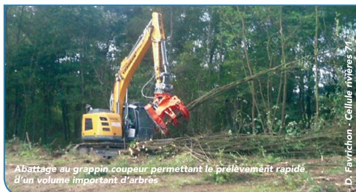
Abattage au grappin coupeur permettant le prélèvement rapide d'un volume important d'arbres
