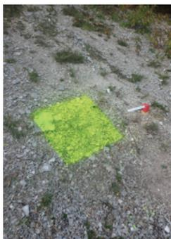
Le procédé consiste à matérialiser à la peinture un carré de 50 cm x 50 cm et à le photographier à intervalles réguliers à la verticale à une hauteur de 1 m. Puis, sur la photographie, on applique une grille millimétrée sur laquelle on calcule la surface de sol peint dégagée. On examine aussi la fluctuation et l'aspect de la déformation de la figure et on calcule la vitesse de cette déformation.
