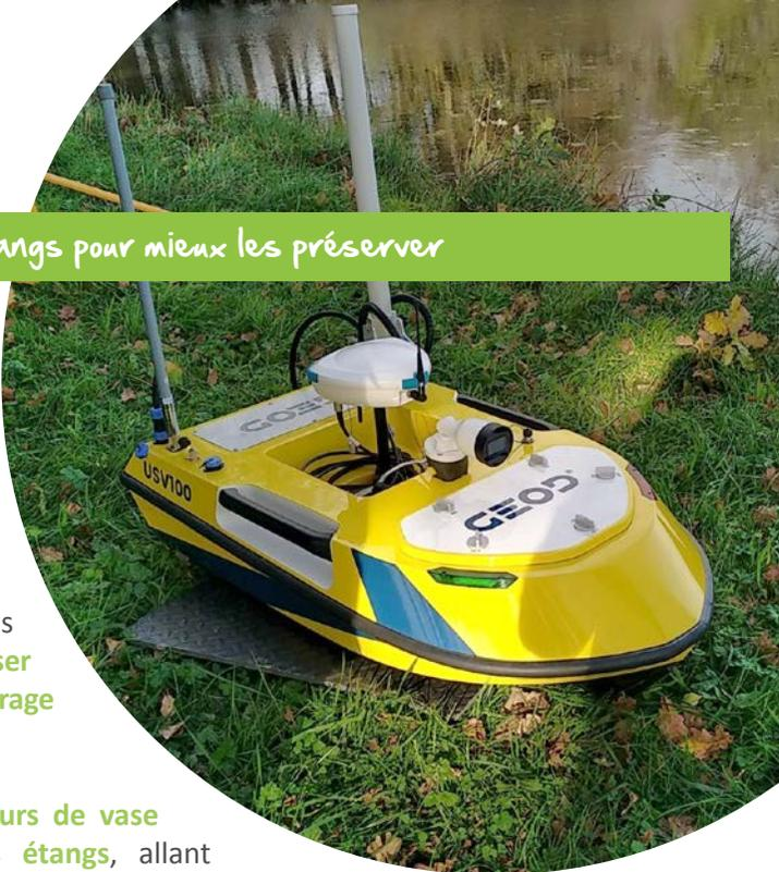
Les niveaux d'envasement des étangs ont été mesurés à l'aide d'un bateau-drone muni d'un échosondeur utilisant des basses et hautes fréquences.
